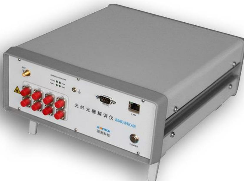
iFBG&eDAQ-S 系列产品是一款基于嵌入式硬件平台和实时操作系统的多通道光纤光栅同步解调仪，采用波长扫描型光纤激光器作为光源，具有多路同步采集及单光路 20dB 信号增益能力。1-5Hz 采样频率可以测量低速变化的温度、应变等物理参数。每个光学通道具有 80nm 波长范围（1510~1590nm），单通道可同时连接多个 FBG 传感器（取决于传感器波长范围）。
