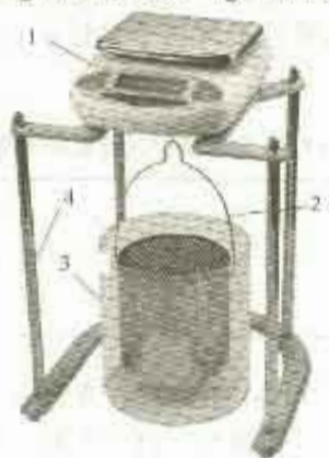
图 4.2.2 水中称量装置示意图
