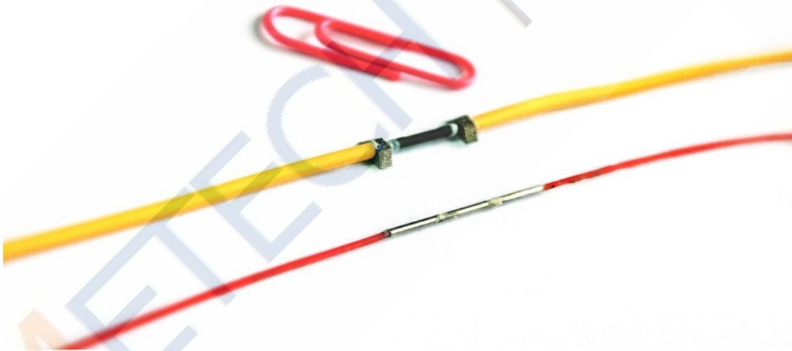
微型光纤光栅应变传感器兼有细径管保护式和夹持式的优点，直径最小可达 1mm，既可以埋入结构中也可以通过辅助构件安装于结构表面。该传感器基于应变增敏/减敏封装机制，通过调节封装工艺中的参数，可以灵活改变传感器的应变灵敏度系数。是目前国内尺寸最小的光纤光栅应变传感器。
